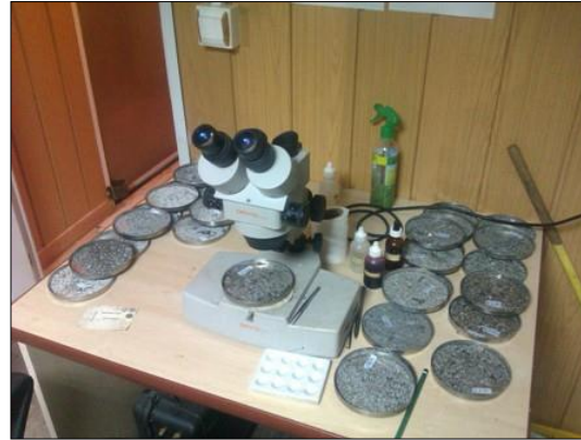
Şekil 5.13. Sondaj ile kesilen kayaç kırıntıları mikroskopta incelenir. Litolojik kuyu loguna işlenir
